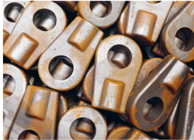
> Links: Brennzuschnitte für die Herstellung von Rohrlagern Typ 49
